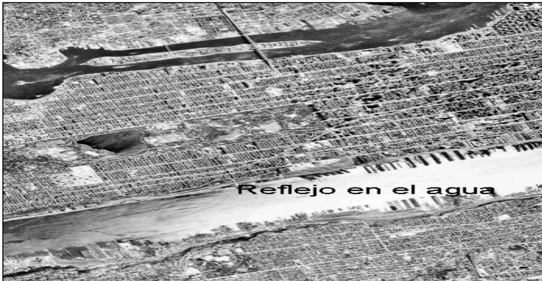
Figura 3.4 Visualización del agua en Blanco/Negro y en Infrarrojo Blanco y Negro de un espejo de agua; Cámara RMK A 15/23, escala original 1/7.000. (Carl Zeiss) (Lasselin y Darteyre, 1991).
