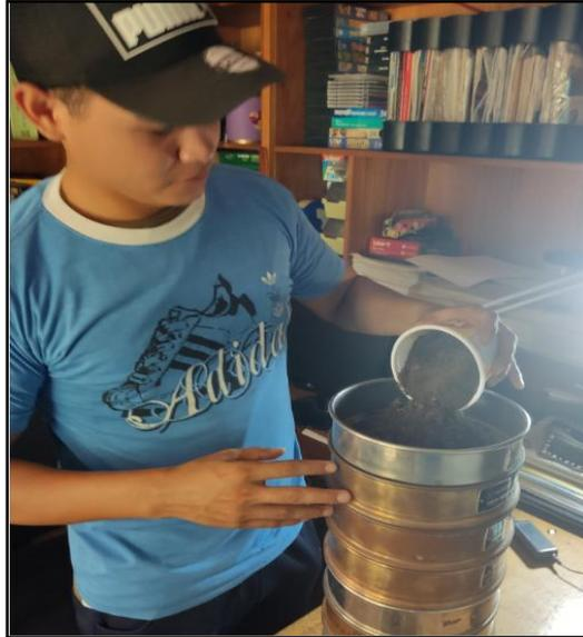
Figura 5.2 Colocación de suelo seco para tamizado.
