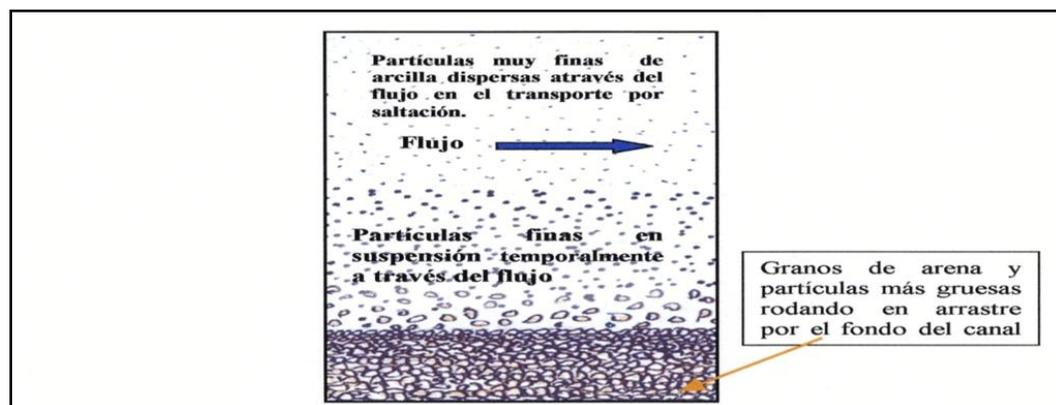
Figura 3.6 Flujo de corriente a través de la capa de arena, limo y arcilla mostrando su medio de transporte (Modificado de Hjulstrom, F., 1935).
