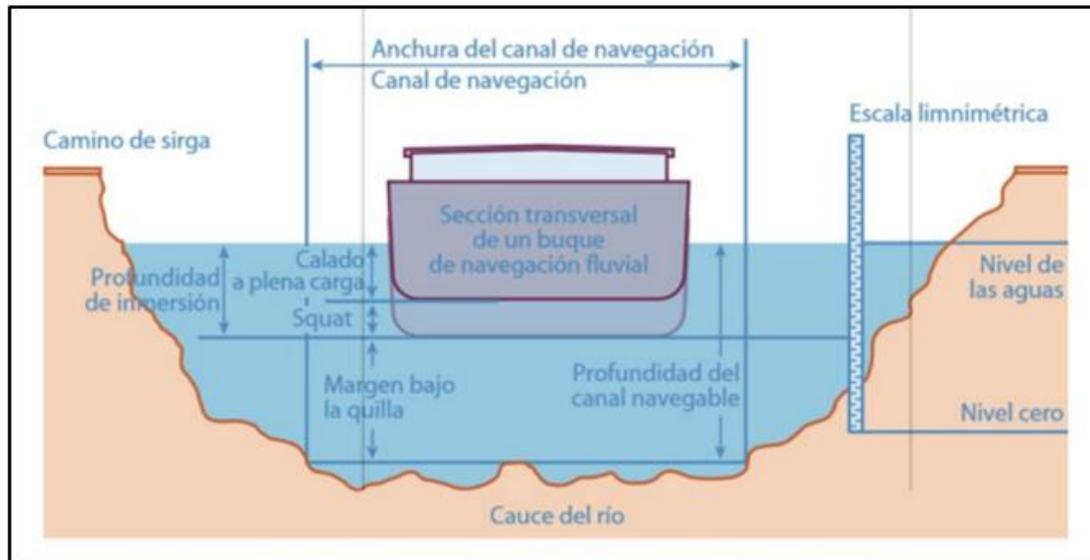
Figura 2.8 Esquema gráfico del canal navegable (Armada Bolivariana, 2017).
