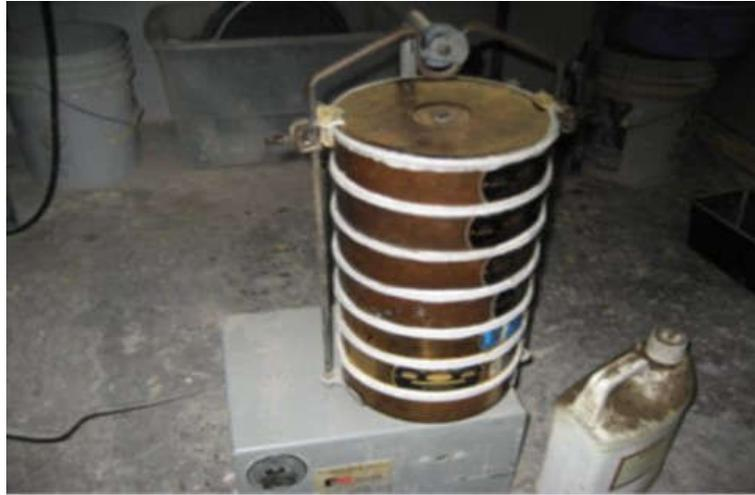
Figura 3.5 Colocación de la torre de tamices en el Ro-tap (Boscarello Carlos, 2021).
