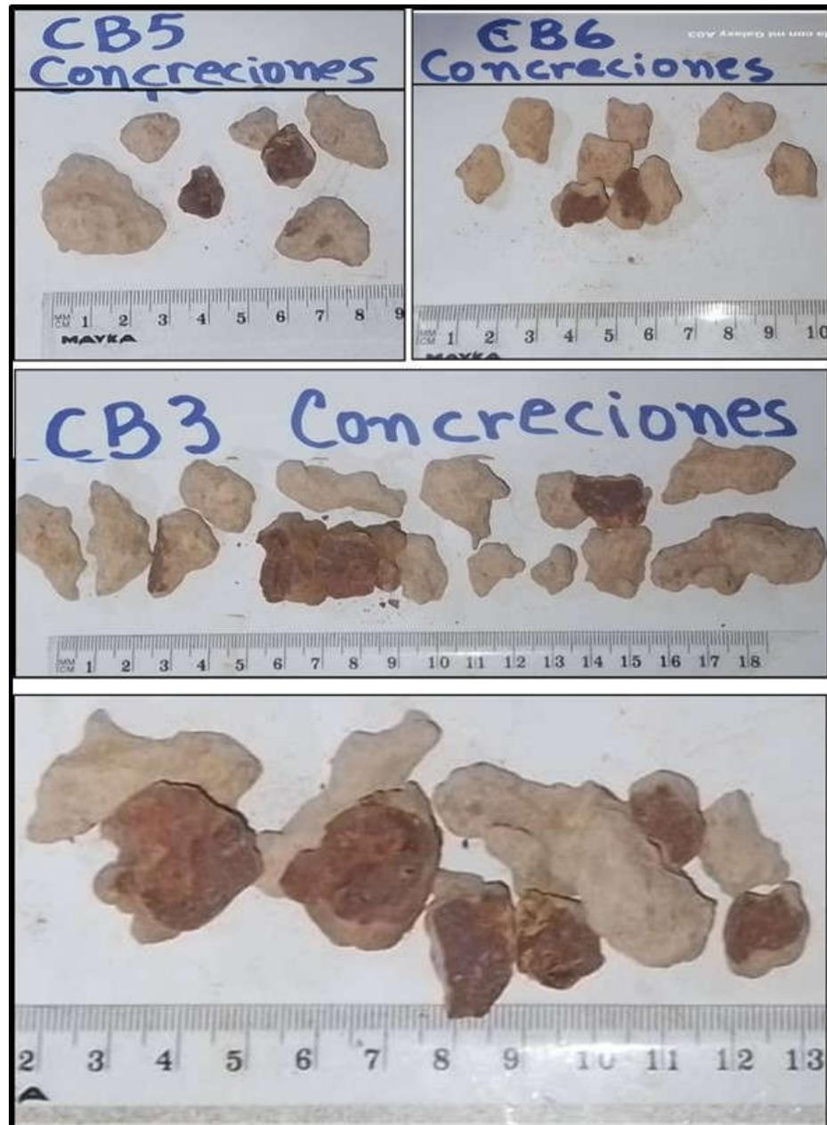
Figura 5.3 Concreciones ferruginosas, con hematita, de las calicatas CB5, CB6 y CB3.
