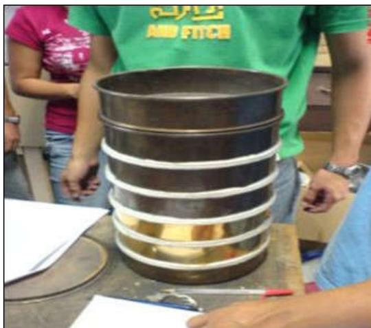
Figura 3.4 Armado de la torre de tamices.
