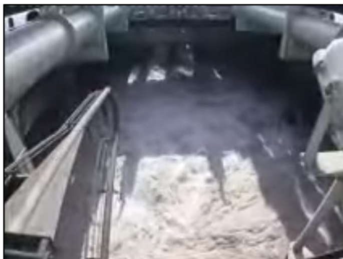
Figura 5.11 Imagen de la tolva de la draga donde se toman las muestras de suelos.
