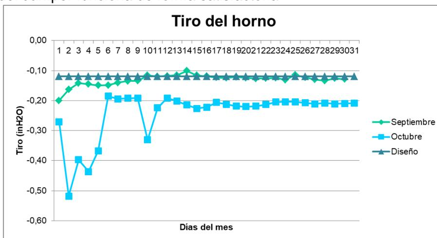
**Figura 4.21 Comportamiento del tiro del d mper en el horno F-1101A, correspondiente a septiembre y octubre de 2023**
