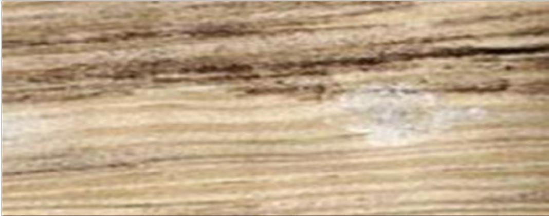
Figura 3.7. Pieza de madera atacada por Moho. (Fritz, 2010)
