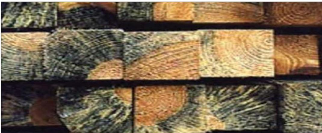
Figura 3.4. Degradación de la madera. (Centro de transferencia tecnológica de la madera, 2007).
