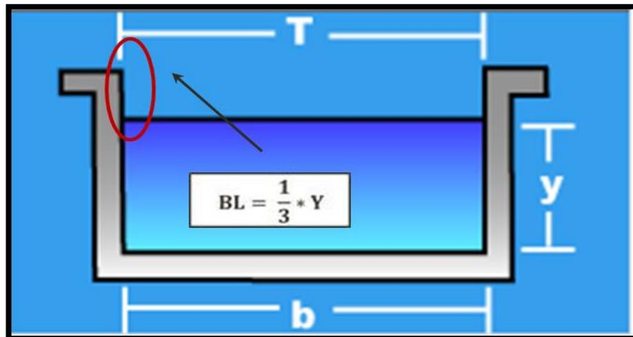
Figura 6.1 Esquema de la sección transversal típica de la torrentera
