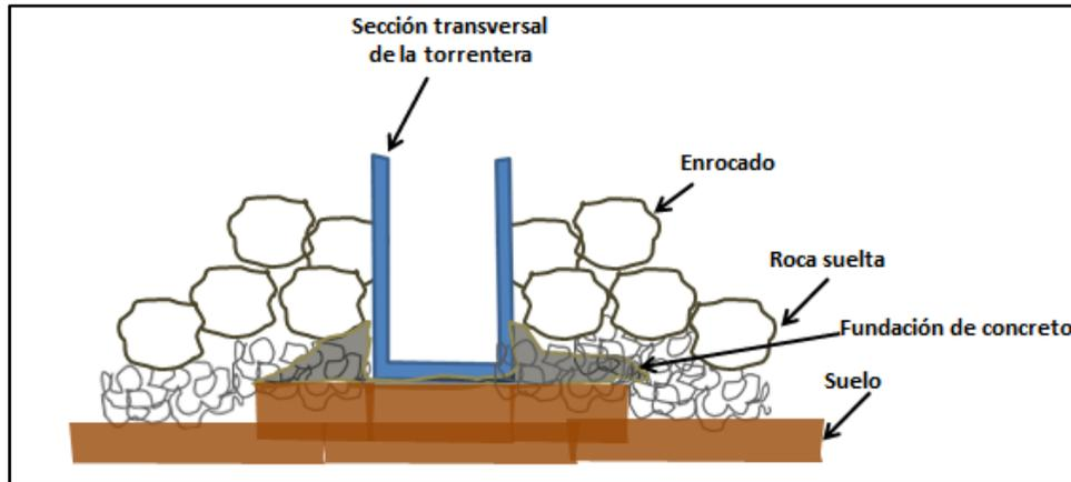
Figura 6.5 Sección transversal de una torrentera con protección de enrocado
