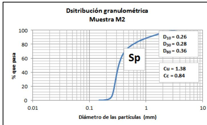
Figura 5.3 Curva de distribución granulométrica de la muestra M2 (Veiga, 2019).
