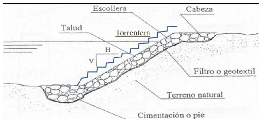
Figura 6.4 Vista lateral de la torrentera en situación de inundación con la protección de enrocado propuesta.
