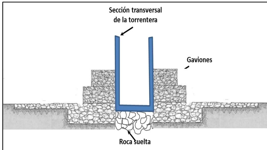
Figura 6.6 Sección transversal de la torrentera con protección de gaviones.
