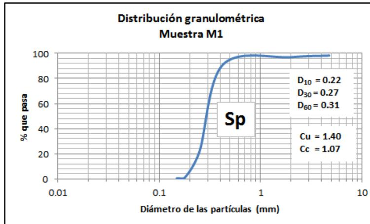
Figura 5.3 Curva de distribución granulométrica de la muestra M1 (Veiga, 2019)..
