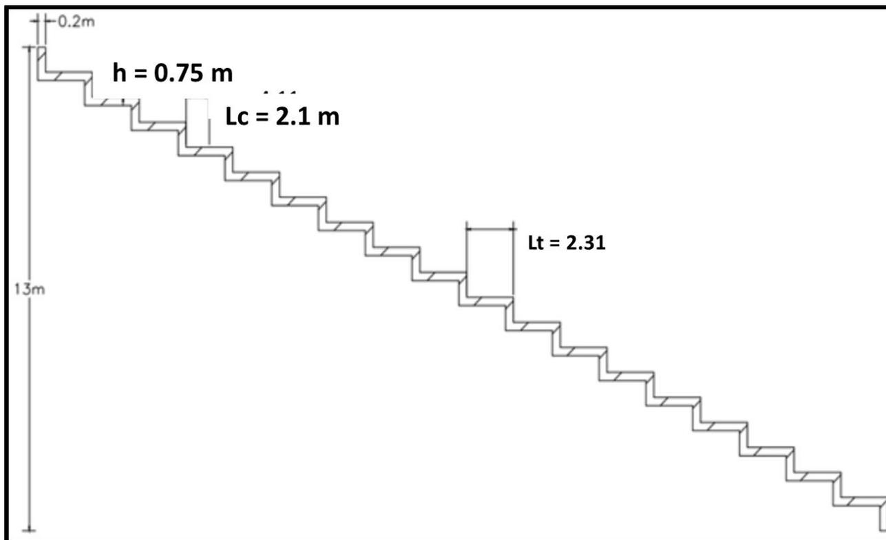
Figura 6.2 Perfil longitudinal de la torrentera
