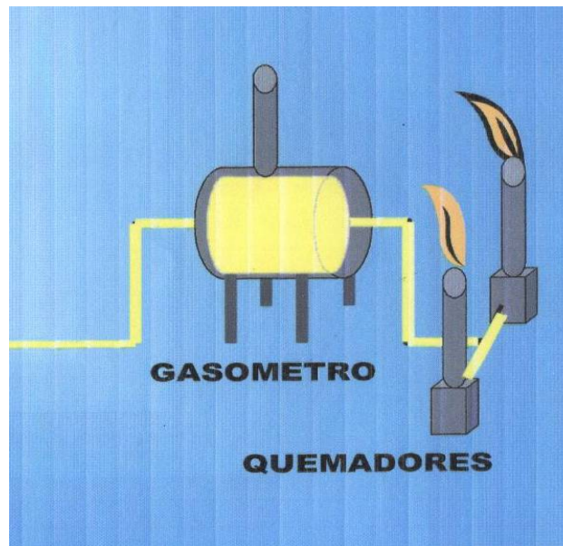
Figura 4.11, Diagrama Esquemático del gasómetro y quemador de gas utilizado en la Planta de Tratamiento de Aguas Residuales Ciudad de Guanta
