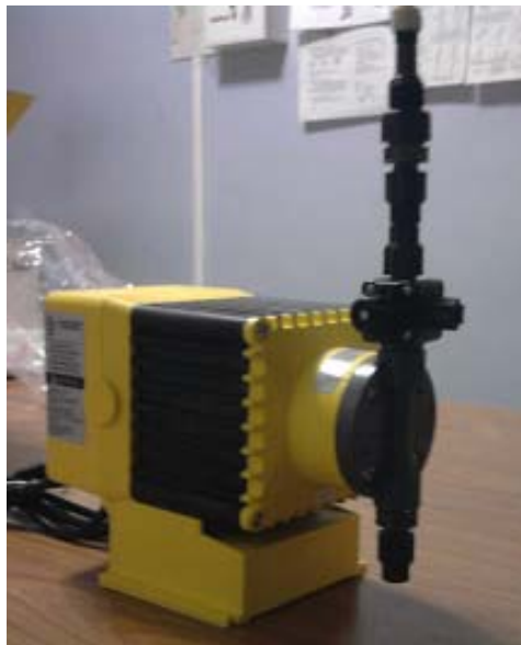
Fig. H3 Dosificador de hipoclorito de calcio de 1 hp de potencia.
