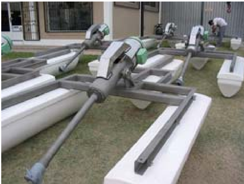
Fig. H2 aireador de flujo descendente de 80 hp
