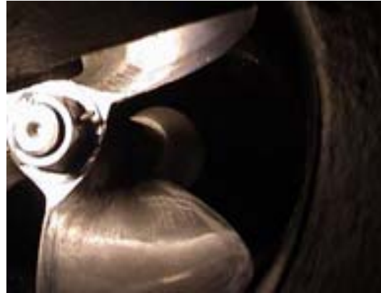
Fig. H1 aireador de flujo descendente de 80 hp
