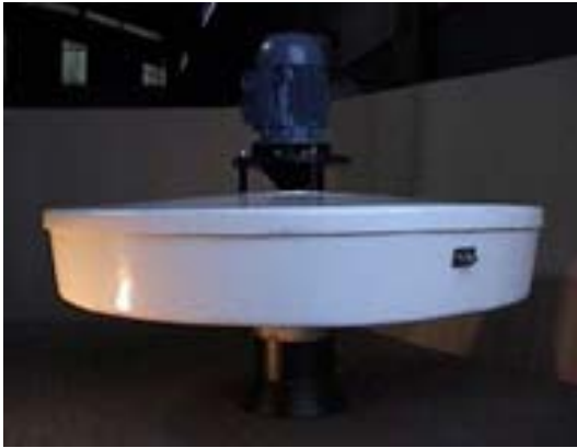
Fig. H1 aireador de flujo descendente de 80 hp
