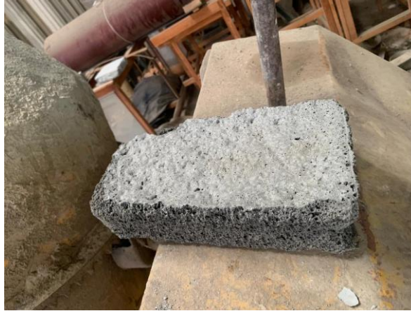
Figura 16. Bloque mal formado como resultado de un mal encofrado. Sin embargo, mantuvo la unión sin desintegrarse, utilizando la mezcla MB7.
