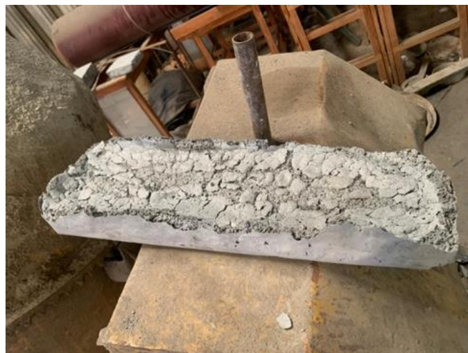
Figura 13. Bloque desintegrado como resultado del uso de jabones líquidos artesanales como la mezcla MB2. Fuente: Autores (2024)
