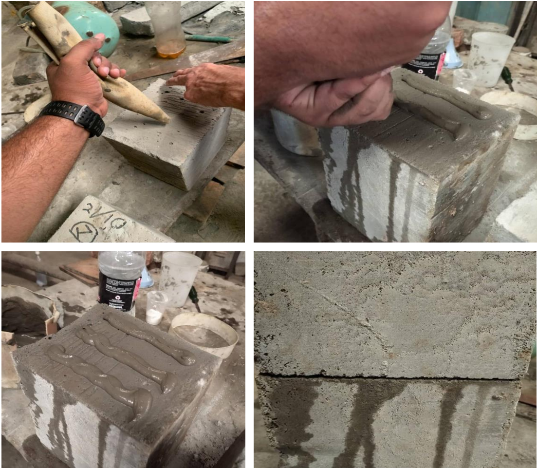
Figura 21. Comprobación de efectividad de la prueba elaborada para adherir los bloques de concreto celular.
