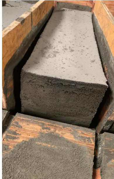
Figura 18. Bloque de concreto celular de prueba incompleto con la mezcla MB8.
