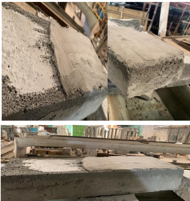
Figura 36. Resultado de la prueba de frisado al bloque de concreto celular.
