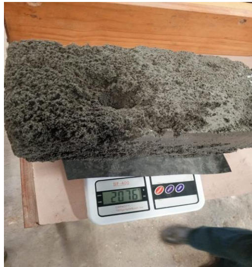
Figura 25. Bloque de concreto celular húmedo en la balanza digital, determinando su peso con una muestra de la mezcla MB12, Fuente: Autores (2024)
