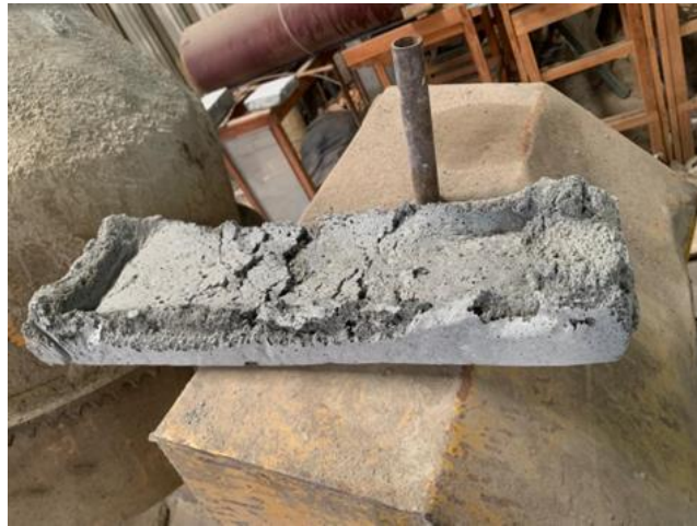
Figura 12. Bloque desintegrado como resultado del exceso de espuma en la mezcla MB1. Fuente: Autores (2024)
