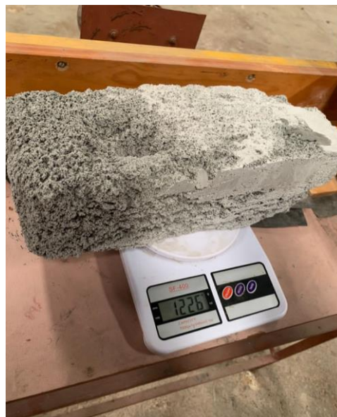
Figura 27. Bloque de concreto celular seco a los dos días de haber sido sumergido para determinar el resto de agua que absorbió el día dos con una muestra de la mezcla MB12. Fuente: Autores (2024).
