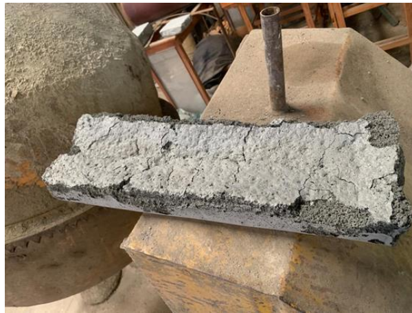
Figura 15. Bloque desintegrado como resultado del uso de elementos como la arena en la mezcla MB6. Fuente: Autores (2024)
