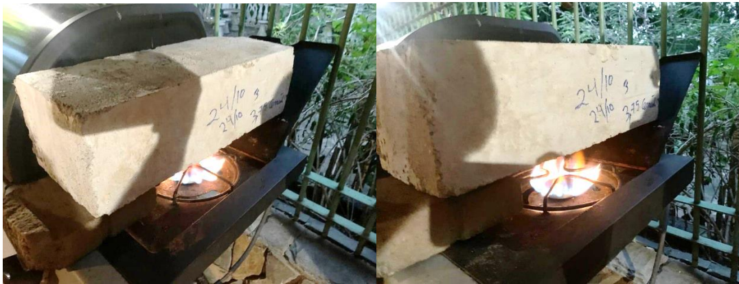
Figura 30. Prueba de fuego directo al bloque de concreto celular con la mezcla óptima MB12. Fuente: Autores (2024)
