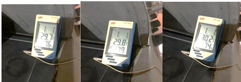
Figura 29. Temperatura en hornilla de cocina a fuego directo, comprobada con el termómetro digital. Fuente: Autores (2024).
