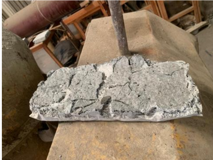
Figura 14. Bloque desintegrado como resultado del uso del jabón Oso blanco como las mezclas MB3, MB4 y MB6. Fuente: Autores (2024)
