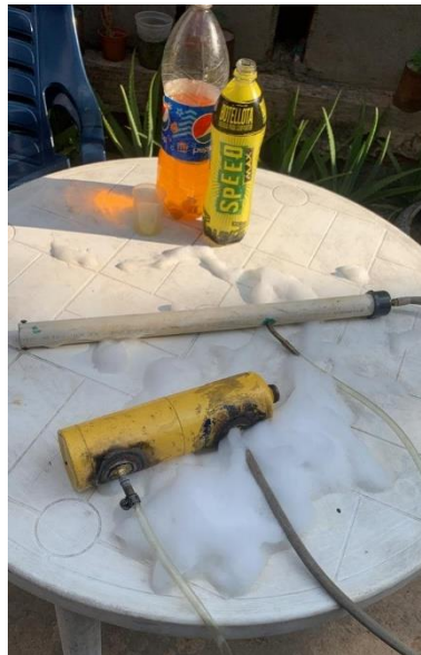
Figura 7. Máquina generadora de Espuma Fuente: Autores (2024).
