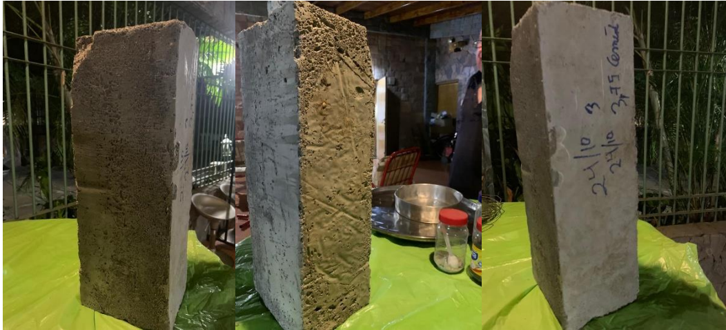
Figura 32. Resultado de las caras restantes del bloque de concreto celular (MB12) que no recibieron fuego directo. Fuente: Autores (2024)
