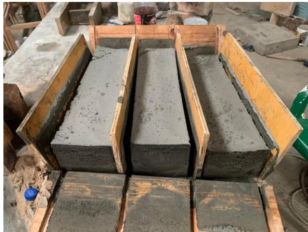
Figura 19. Bloque de concreto celular fabricado con mezclas como MB9, MB10.
