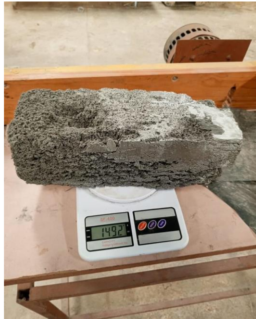
Figura 26. Bloque de concreto celular seco en la balanza digital, determinando su peso el día uno con una muestra de la mezcla MB12. Fuente: Autores (2024).
