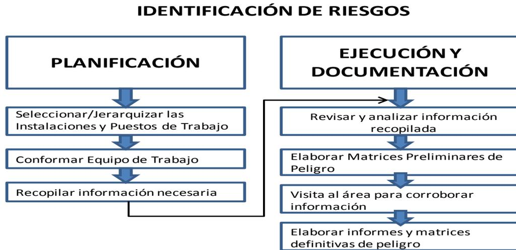
**Figura 3.1. Proceso de identificación de peligros.**
