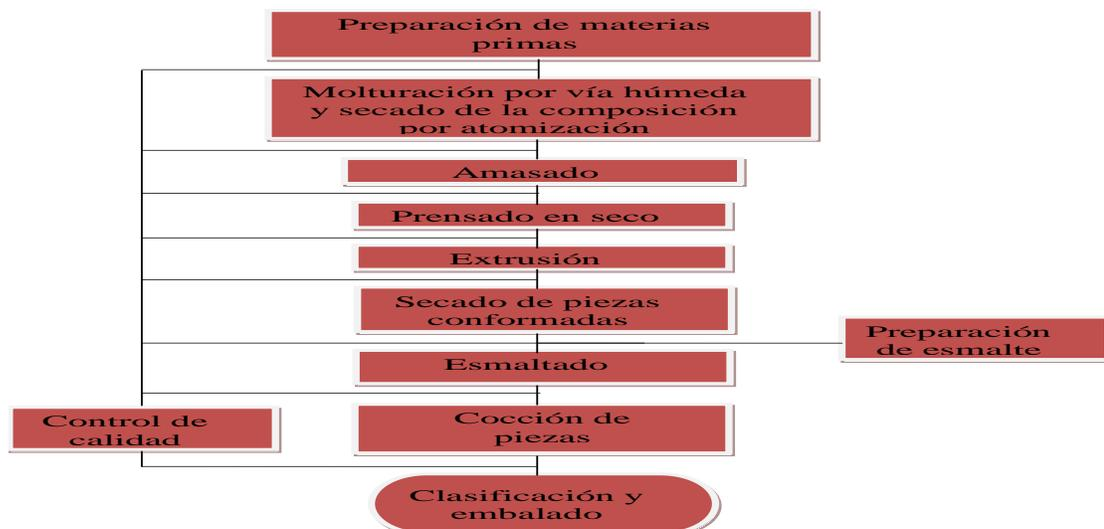
**Figura 4.1. Proceso productivo de la fabricación de las baldosas de cerámica.**
