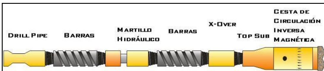
Figura 4.12. Cesta de circulación inversa Fuente: Atina Energy Services Corp (2015)
