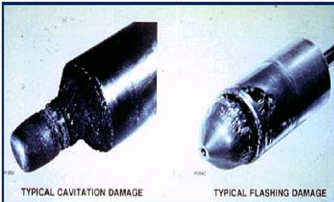
Figura 4.37 Daño por cavitación y flasheo en componentes de las válvulas
