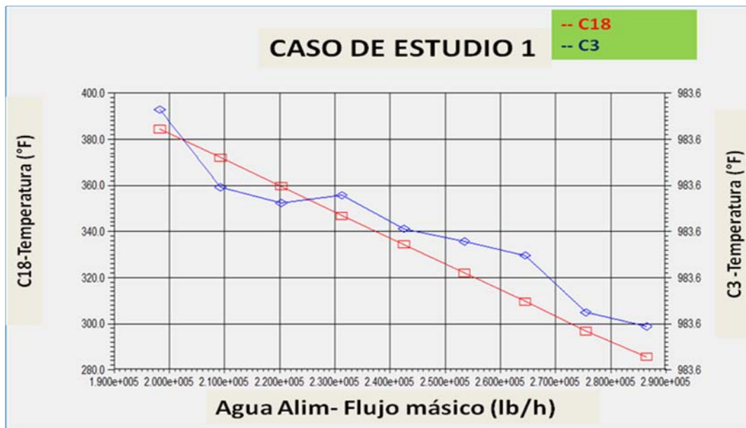
Figura 4.6. Variación de la temperatura de las corrientes C18 y C3 con respecto al flujo de agua de alimentación.
