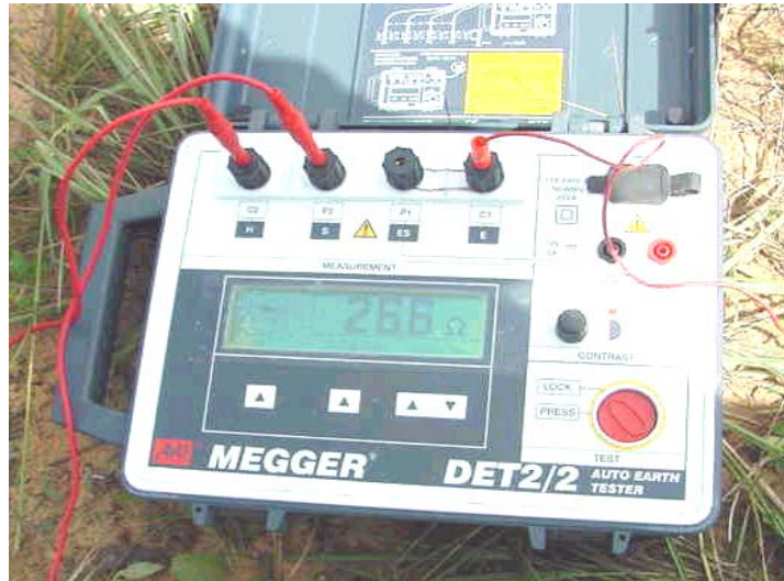
Figura 3.3. Foto del equipo de medición MEGGER DET2/2.
