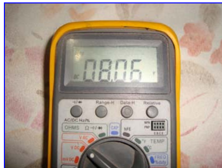
Figura 6.19. Valor de la batería del NC medido por un multímetro. Fuente: Propia.
