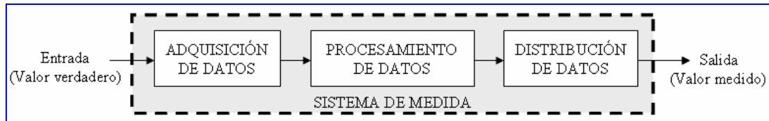
Figura 2.3. Funciones principales de un sistema de medida electrónico. [5]
