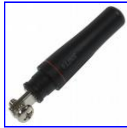
Figura 3.11. Antena seleccionada. ANT-433-PW-LP de Antenna Factor. [69]
