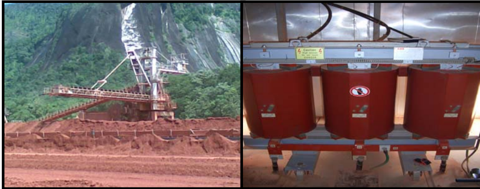
Figura 2.3 Apilador ST 7.09 (Lado derecho), Transformador seco de 400 KVA (Lado Izquierdo) [El Autor].
