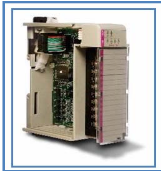
Figura 4.5. Módulo de Conteo de Pulsos 1769-HSC. [11]
