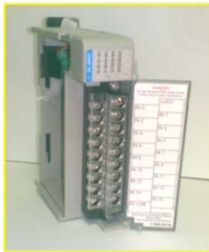
Figura 4.6. Módulo de Entrada Discreta 1769-IQ16. [11]
