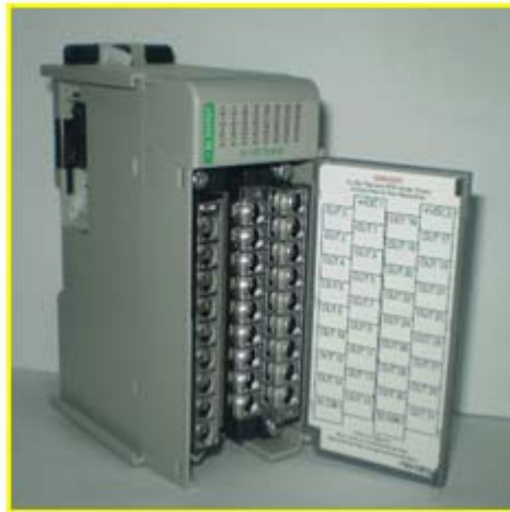
Figura 4.8. Módulo de Salidas a discretas 1769-OB32. [11]
