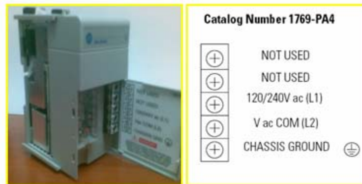
Figura 4.2. Fuente de Alimentación 1769-PA4.
